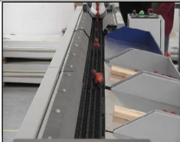
E' una calibratrice di tipo modulare per la calibrazione di frutta del tipo: Mandarini, pomori piccoli, Susine, kiwi, Albicocche e tutti i frutti tondeggianti in generale di piccola dimensione.
